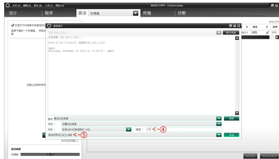
(3) 如需将该回路关闭, 需设置亮度为 0, 控制命令为#OUTPUT,12,1,0, 即将“F3 卧室壁灯关闭”。
