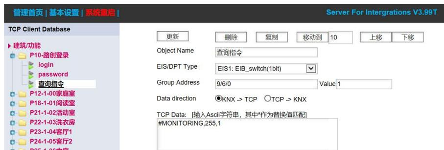
注：LUTRON登陆用户名和密码需要在“路创设计软件”中的“工具”->“集成配置”->“远程登陆服务登陆”中进行设置
