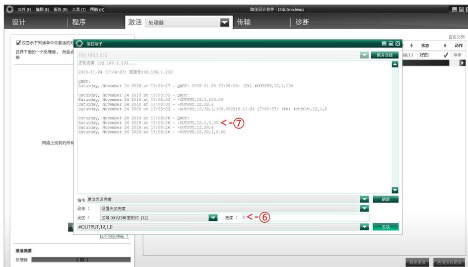
对于灯光亮度调节 (相对/绝对调光), 控制命令格式: #OUTPUT, Component Number, Action Number, Parameters, 反馈命令为: ~OUTPUT, Component Number, Action Number, Parameters。
