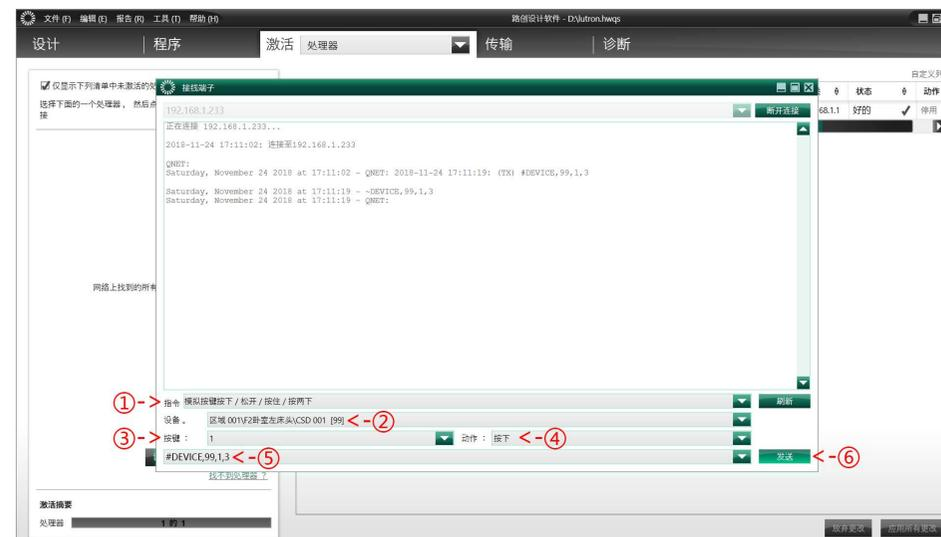
控制 (反馈) 命令格式为: #(~)DEVICE, Integration ID, Component Number, Action Number, Parameters。
